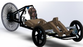
Photo : CAO complète du châssis avec pilote
